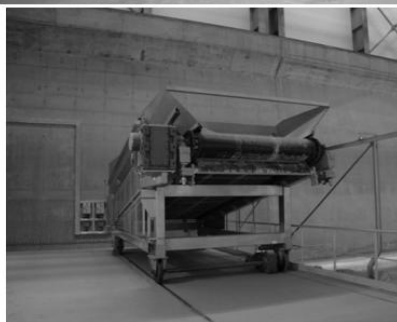
Rys. 11. Zdjęcia zbudowanego w EC Siekierki magazynu gipsu z wydzieloną strefą gipsu pozaklasowego i instalacją awaryjnego załadunku gipsu
